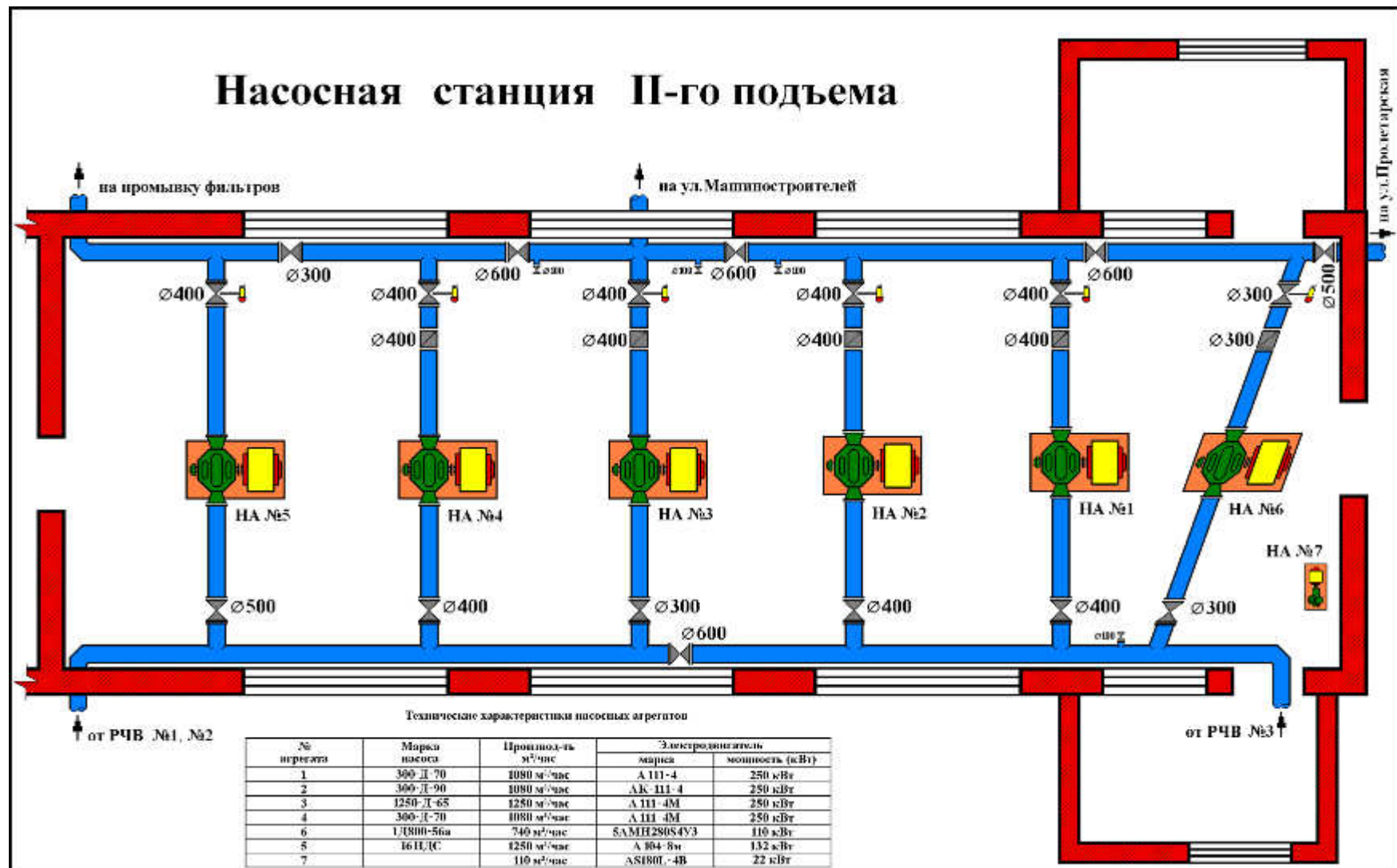
Рисунок 1.3.3. Технологическая схема насосной станции II подъема Речного водозабора
